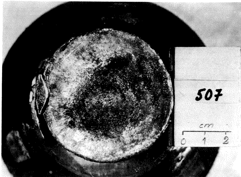
Fig. 17 SPRICKA I DUBB 507 (CRG 507)
